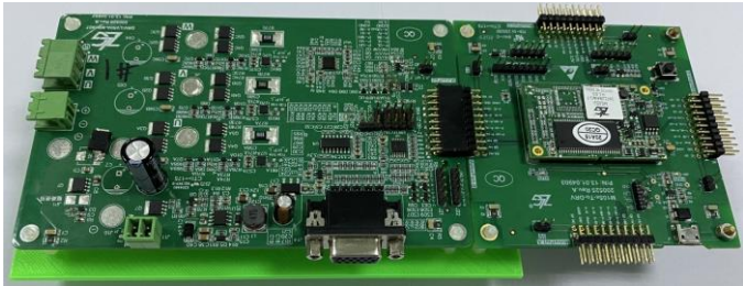
DRV-LV50A驱动板 + i.MX RT1052核心板
