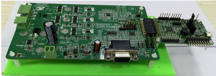
DRV-LV50A驱动板 + KV3x核心板
