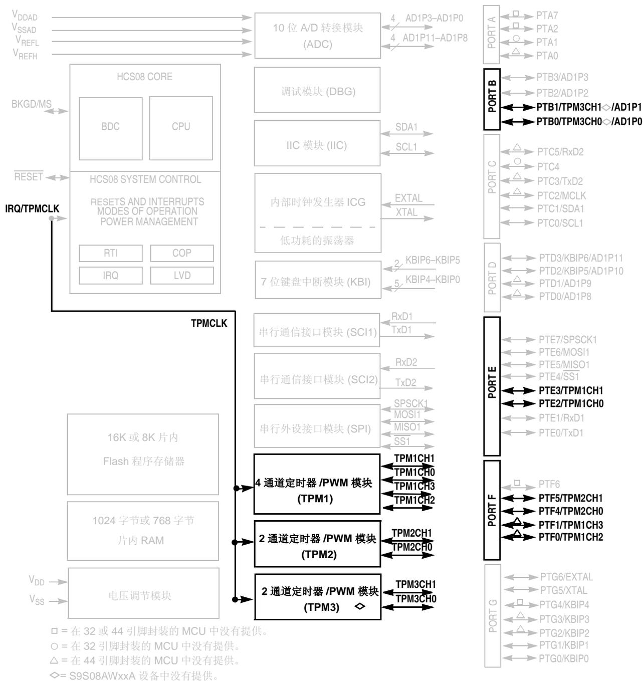
图 10-1. 显亮 TPM 模块及其引脚的 MC9S08AC16 框图
