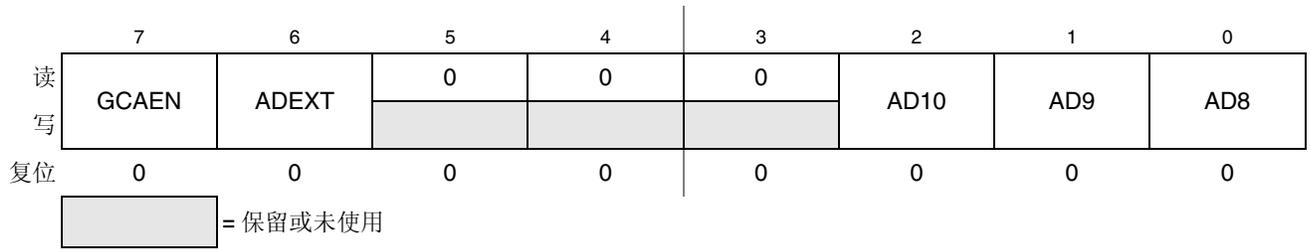
图 13-8. IIC 控制寄存器 2 (IICC2)
