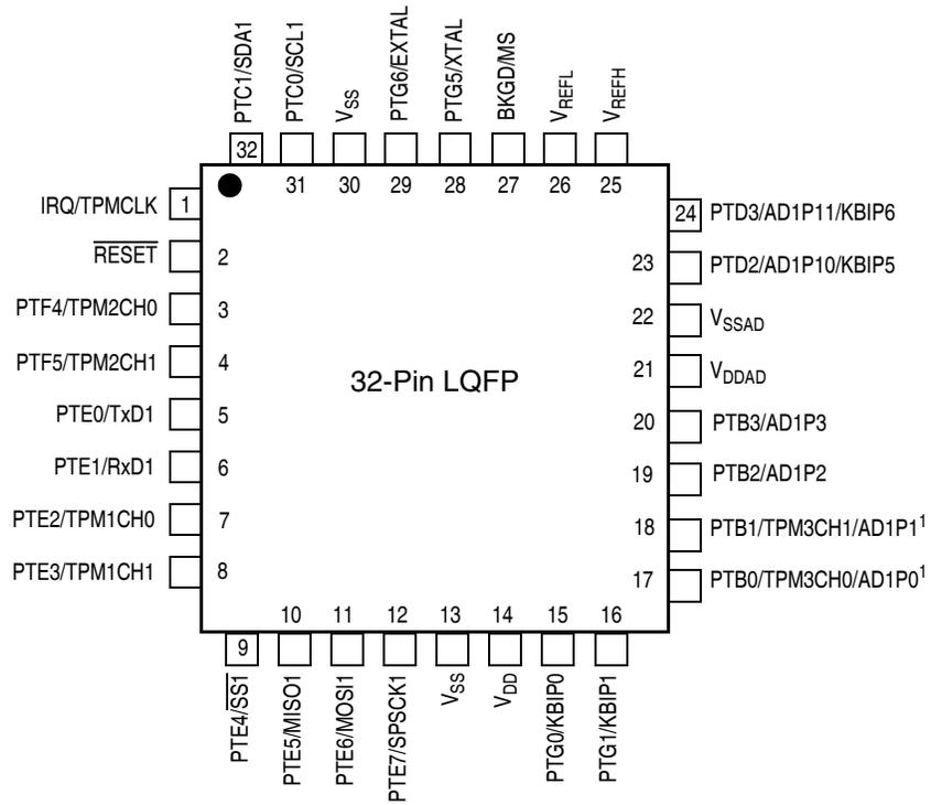
图 2-3. MC9S08AC16 系列 32 引脚 LQFP 封装
