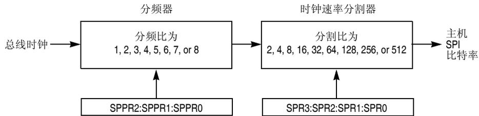
图 12-4. SPI 波特率发生器
