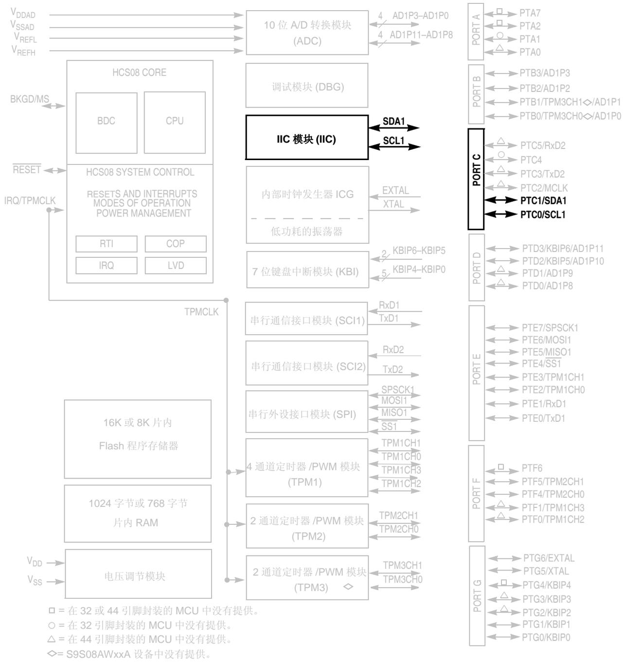
图 13-1. 显亮 IIC 模块和引脚的 MC9S08AC16 框图
