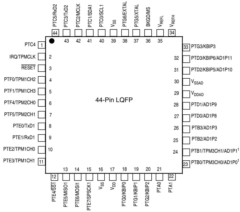
图 2-2. MC9S08AC16 系列 44 引脚 LQFP 封装<sup>1</sup>
