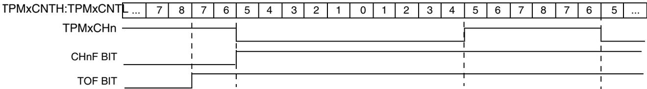
图 10-6. 中心对齐 PWM 模式的低真脉冲
