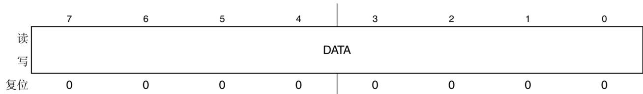
**图 13-7. IIC 数据输入输出寄存器 (IICD)**
