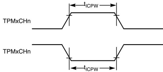
图 A-15. 定时器输入捕获脉冲
