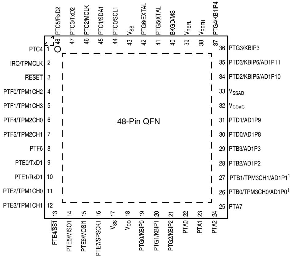
图 2-1. MC9S08AC16 系列 48 引脚 QFN 封装<sup>1</sup>
