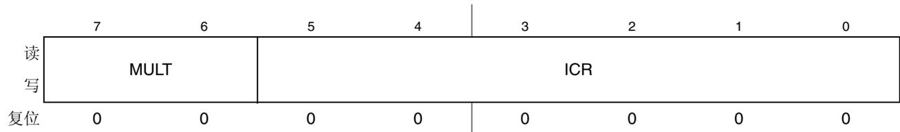
图 13-4. IIC 频率分频寄存器
