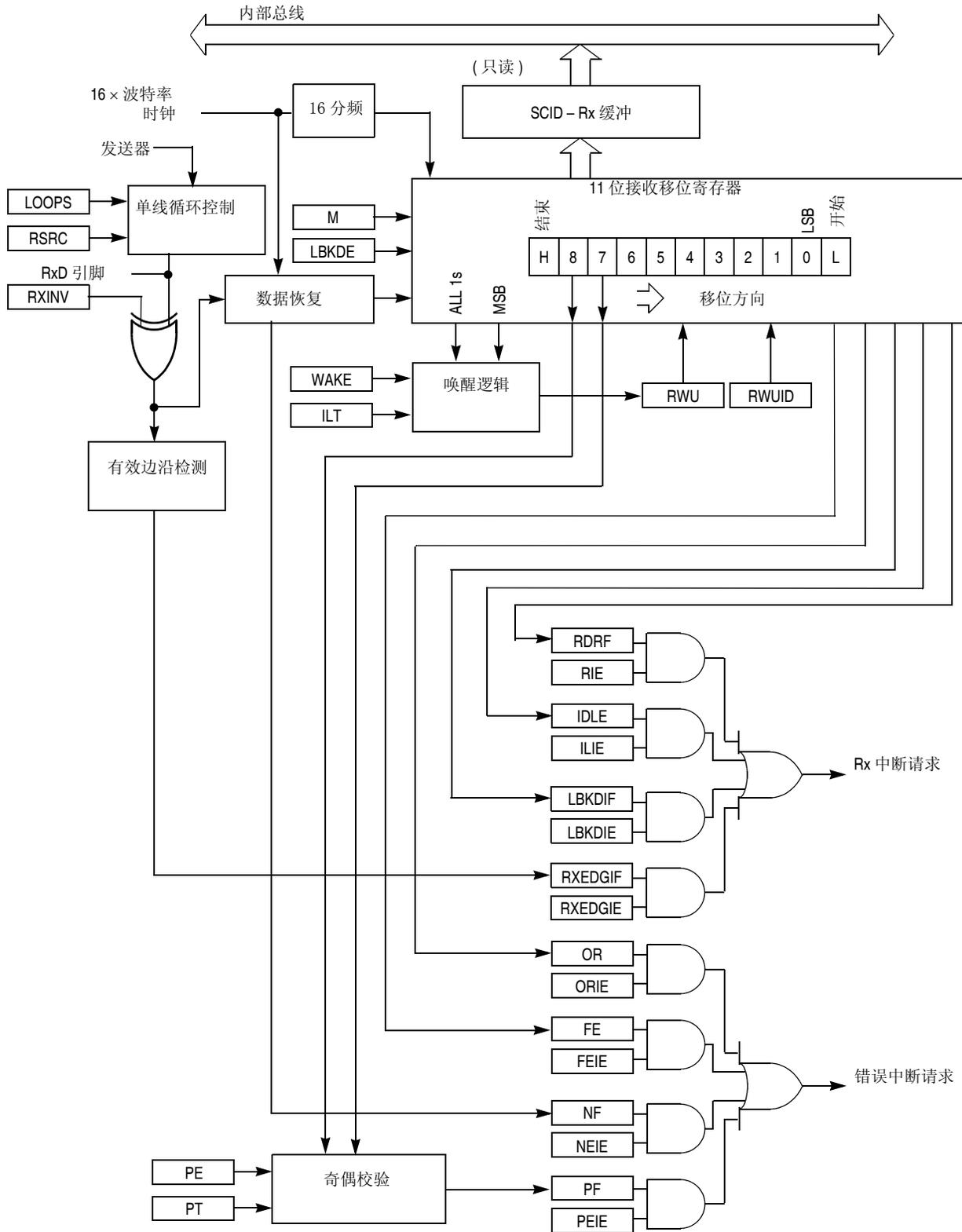
图 11-3. SCI 接收器原理结构图
