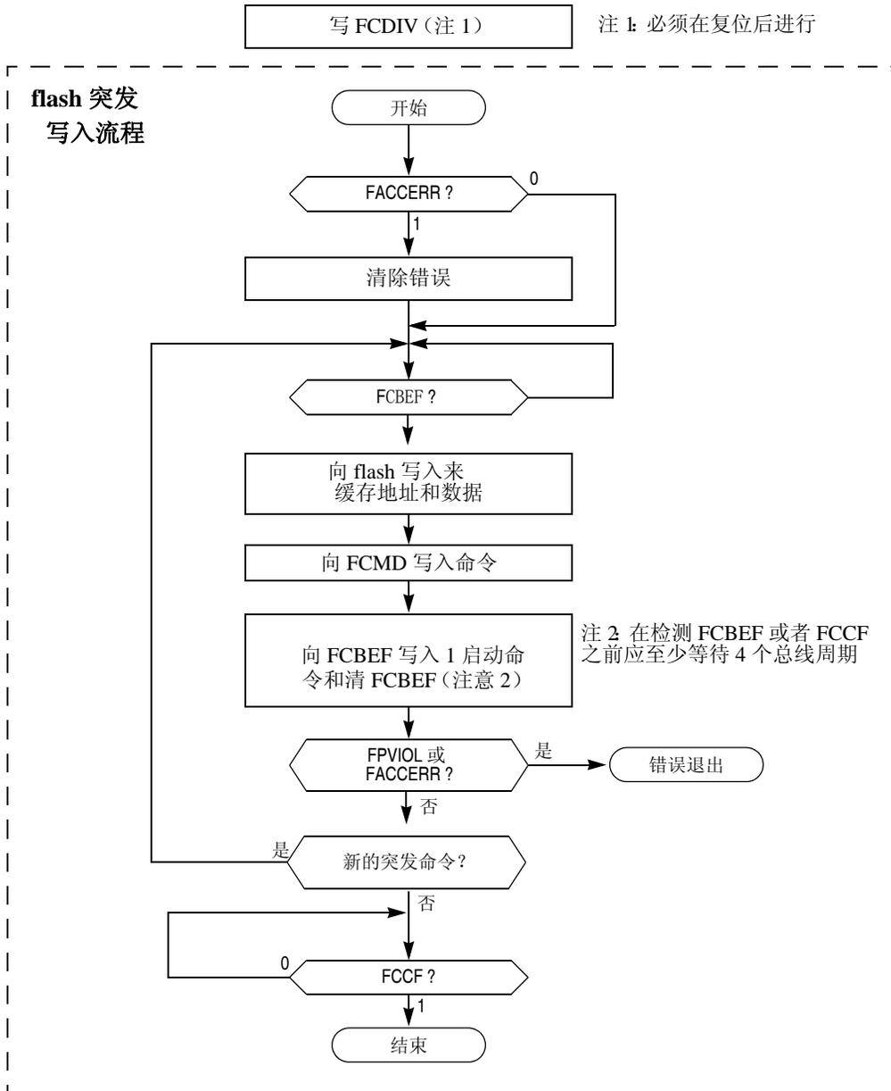
图 4-3. Flash 突发写入流程图
