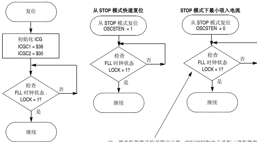
注：要求振荡器开始并稳定工作。实际时间取决于晶振 / 谐振器和外部电路
