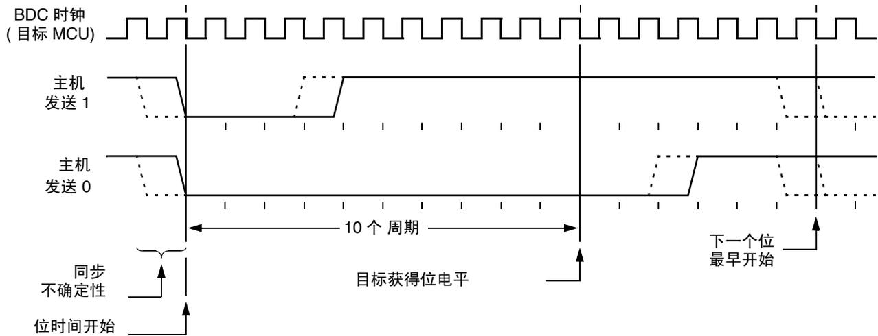
图 15-2. BDC 主机到目标方向串行位时序
