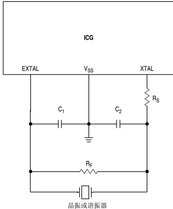
图 9-5. 使用外部参考频率的连接
