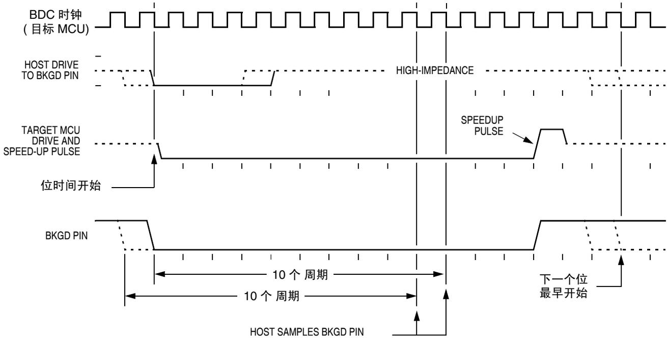
图 15-4. BDM 目标 - 到 - 主机串行位时序 (逻辑 0)
