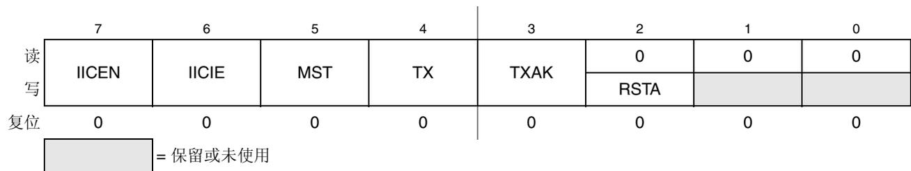
图 13-5. IIC 控制寄存器 (IICC1)
