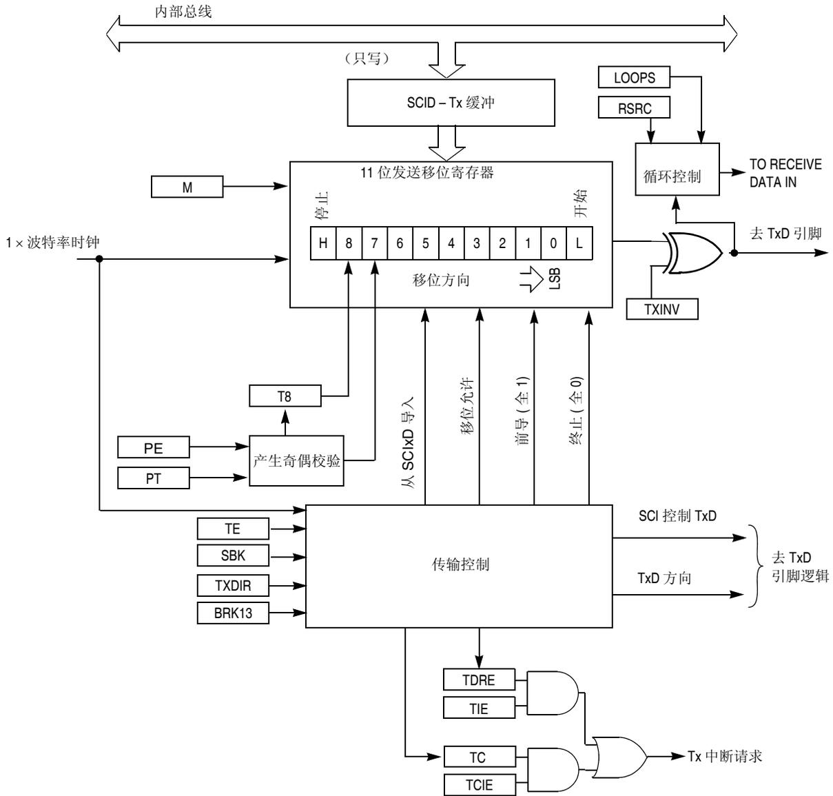
图 11-2. SCI 发送器原理结构图
