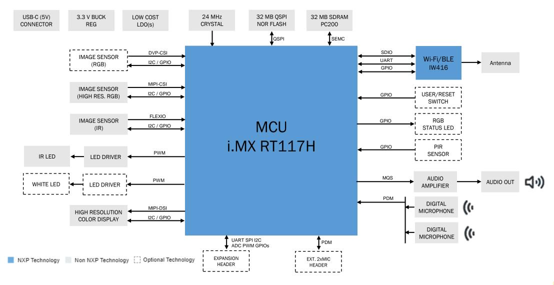
SLN-TLHMI-IOT (i.MX RT117H) EDGEREADY SOLUTION SOFTWARE BLOCK DIAGRAM
