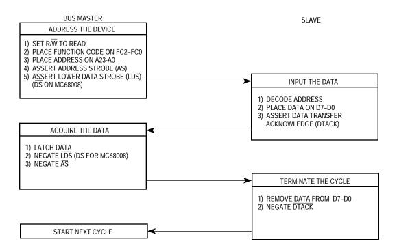
Figure 4-1. Byte Read-Cycle Flowchart
