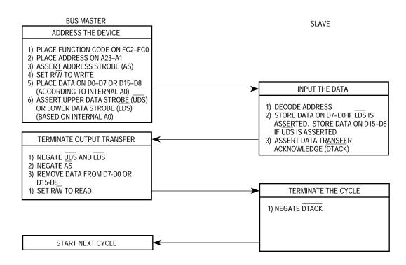
Figure 5-6. Byte Write-Cycle Flowchart
