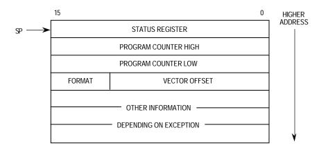
Figure 6-6. MC68010 Stack Frame
