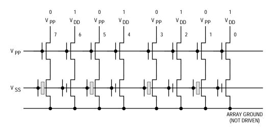
Figure 4-6. Programming an EEPROM Byte
