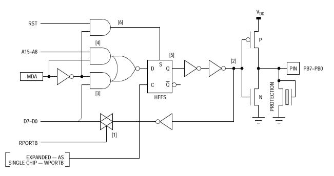
Figure 7-8. Port B Pin Logic
