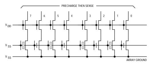
Figure 4-7. Reading an EEPROM Byte
