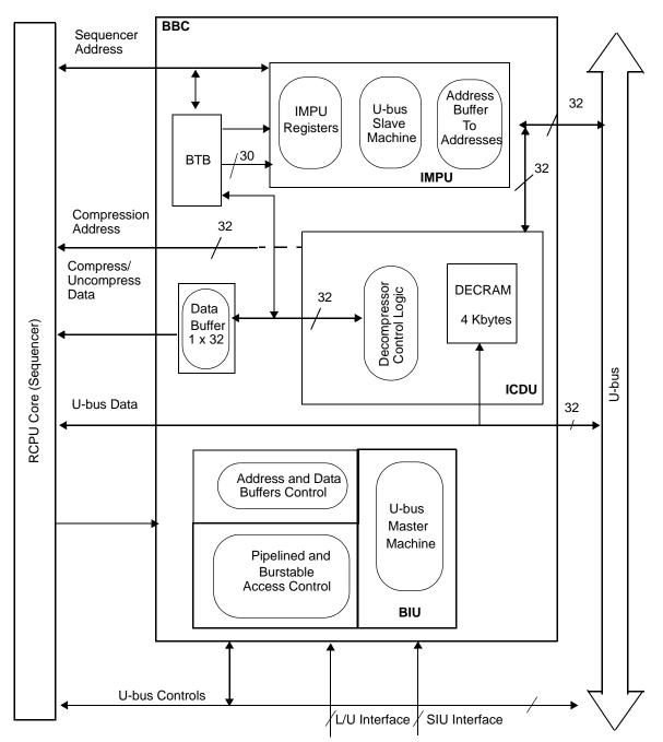
Figure 4-1. BBC Module Block Diagram
