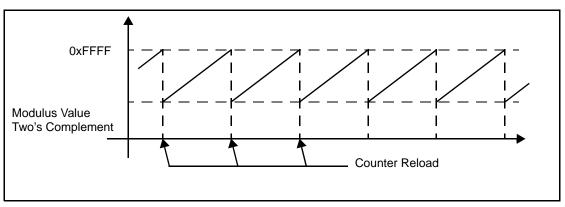
Figure 17-11. MMCSM Modulus Up-Counter
