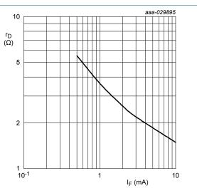
$T_i = 25 \,^{\circ}\text{C}$ ;  $f = 100 \, \text{MHz}$ .
