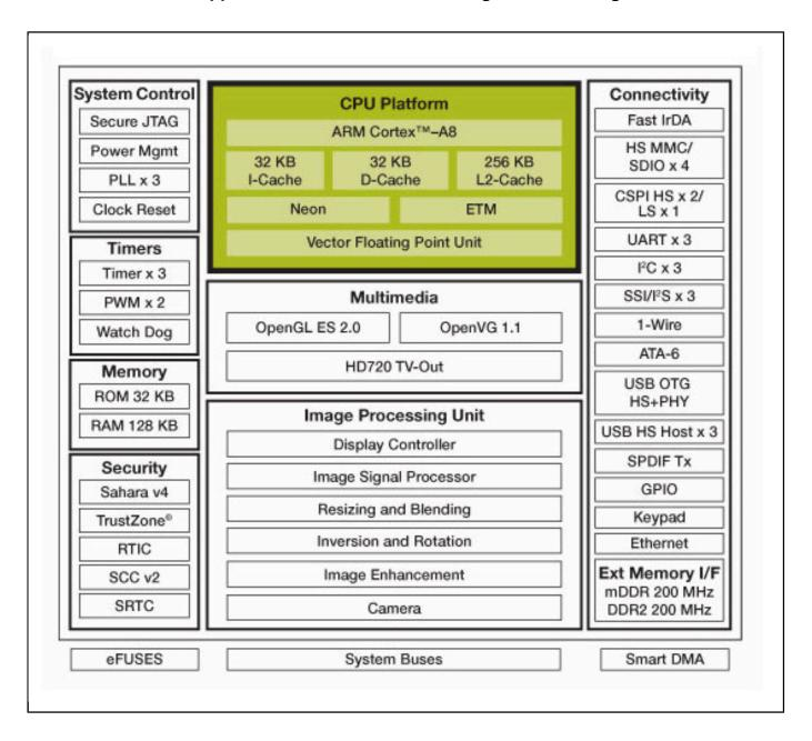
View additional information for 应用处理器 - 硬件加速2D和3D图形, 高性能, 低功耗, ARM® Cortex®-A8内核.
