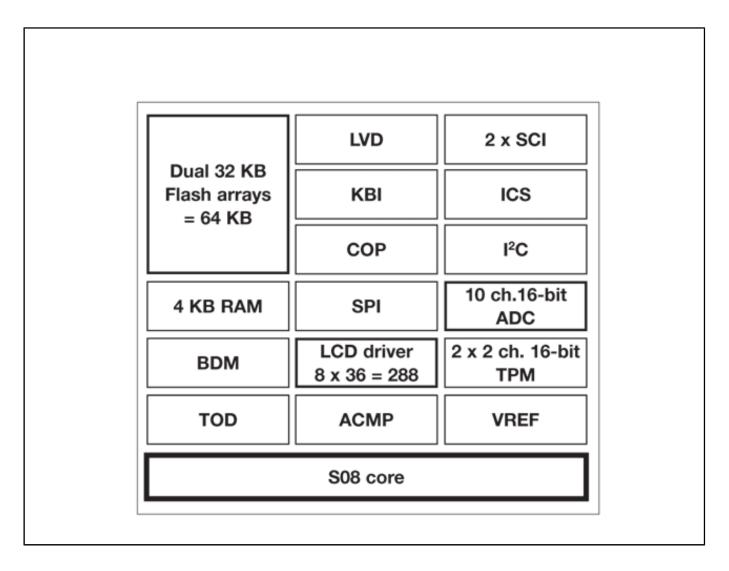
View additional information for 带 LCD 驱动器的 8 位超低功耗 LH 微控制器.
