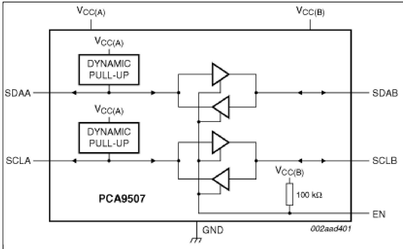
View additional information for [适用于HDMI DDC I2C总线和SMBus的2线串行总线扩展器](#).
