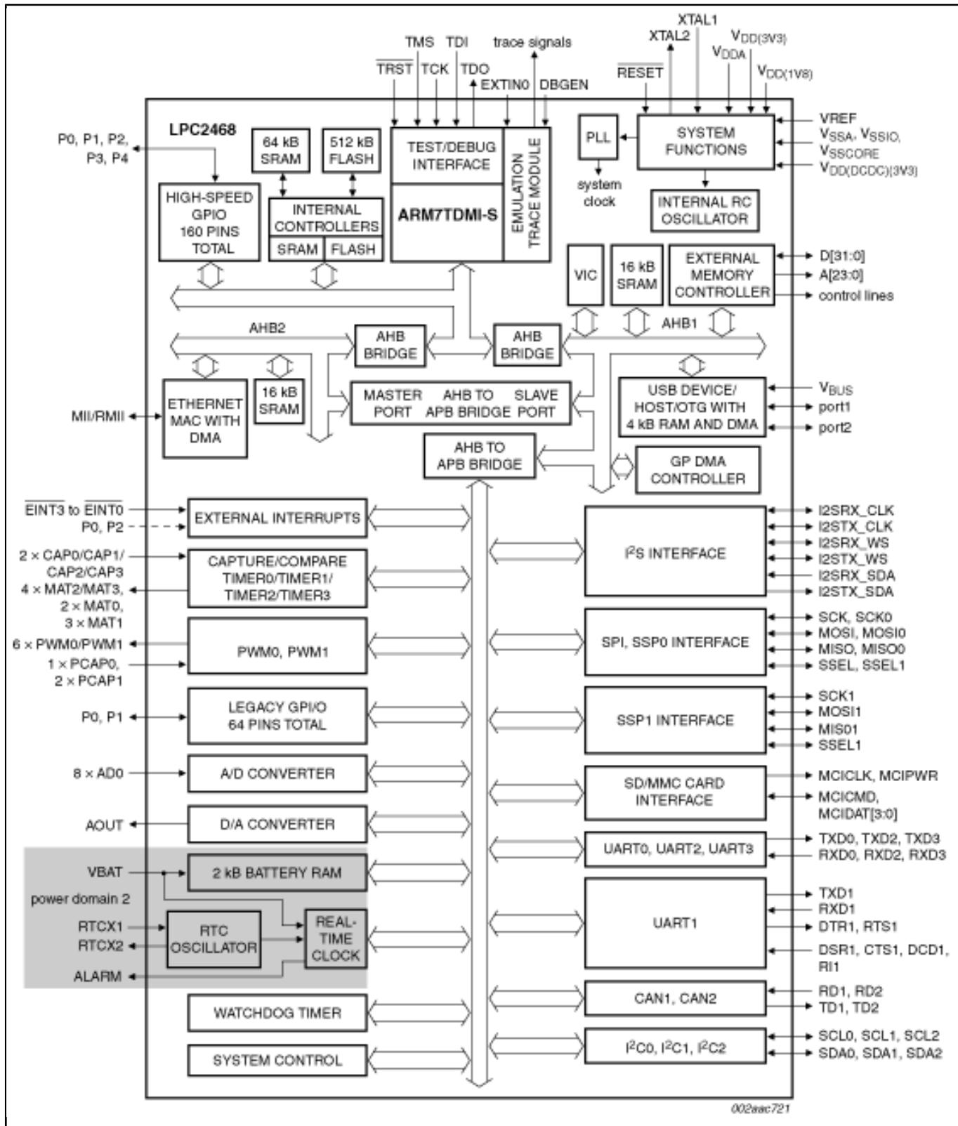
View additional information for [单芯片16/32位微控制器：512 kB闪存、以太网、CAN、ISP/IAP、USB 2.0设备/主机/OTG、外部存储器接口](#).
