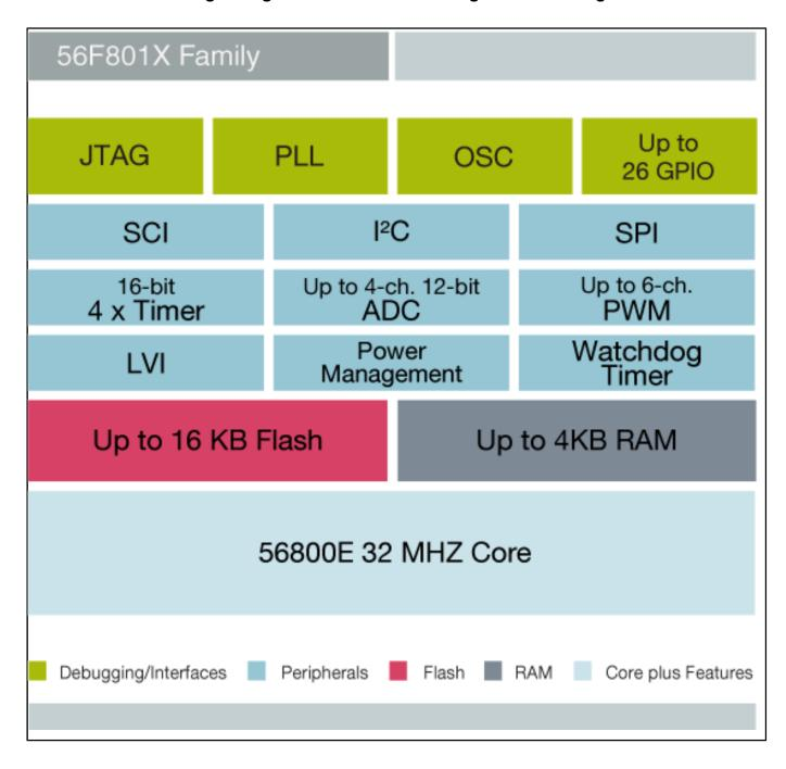
View additional information for 面向电机控制应用的数字信号控制器.
